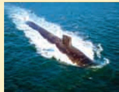
Figura 6.8. Un submarino utiliza el principio de Arquímedes para navegar bajo el agua o en la superficie. Para controlar su peso, los submarinos están equipados con tanques de lastre. Para sumergirse o emerger, usan los tanques de proa y popa, llamados tanques principales, que se abren y se llenan completamente de agua para sumergirse o se llenan de aire a presión para emerger.
