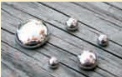
Figura 6.21. El mercurio líquido no moja la superficie de contacto porque la fuerza de cohesión entre sus moléculas es mayor que la fuerza de adhesión con la madera.
