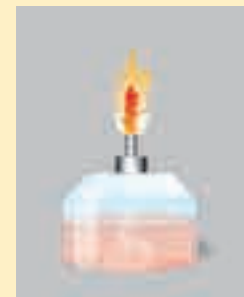
Figura 6.24. La mecha funciona como un elemento absorbente del alcohol, debido al efecto de capilaridad.
